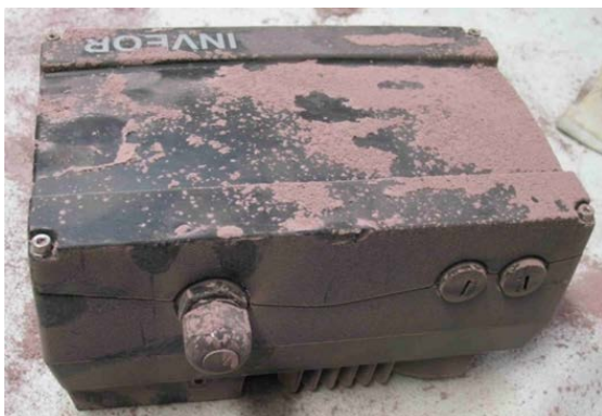
Bild 2: INVEOR nach Staubtest: IP 65 Schutzart schützt auch vor Wüstenstaub
