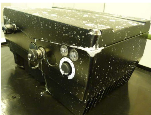
Bild 3: INVEOR nach Salznebeltest: Die aggressive Umgebung kann dem Aluminiumgehäuse nichts anhaben
