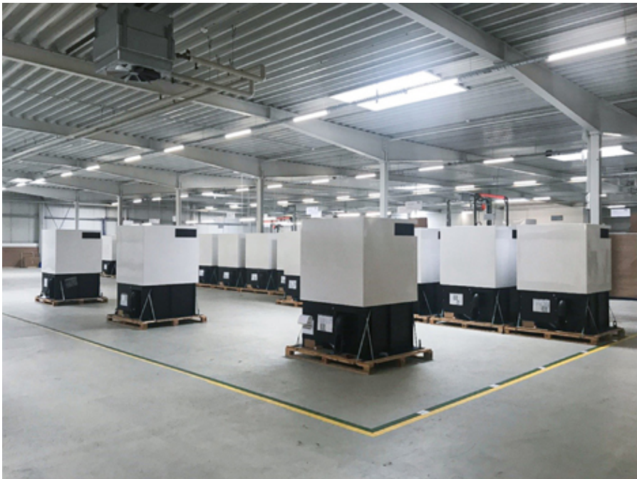
Bild Nr. 09-02 KY_Montage.jpg. In partnerschaftlicher Zusammenarbeit von ADS-TEC und H. P. Kaysser entstehen die Booster für das Schnellladesystem HPC.
